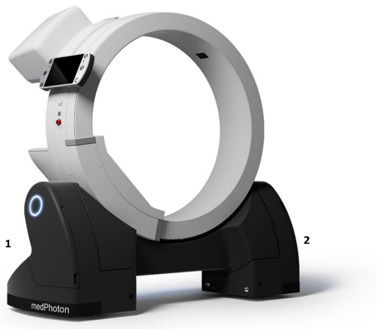
Obrázek 5: Náhled soustavy, zezadu. 1: Levá noha dipodu s přihrádkou na kabel a elektrickými rozhraními. 2: Pravá noha dipodu s prostorem pro ukládání.
