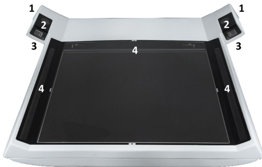
Obrázek 32: Rameno detektoru u varianty ImagingRing m. 1: elektromechanické ochranné zábrany; 2: kamery detektoru; 3: Senzory TOF; 4: Čtyři liniové lasery, které mohou promítat převrácené FOV na pacientovu pokožku
