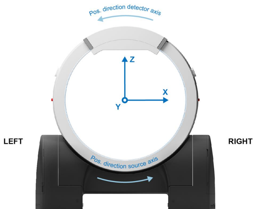
Obrázek 12: Pohled zezadu se zobrazovací soustavou souřadnic (modrá) a pozitivním směrem osy detektoru a zdroje (světle modrá)
