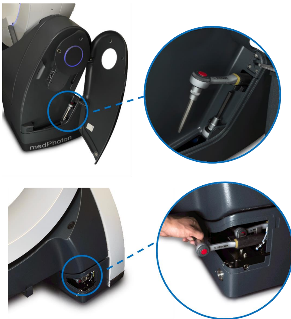
Obrázek 49: Ráčnové klíče s imbusovým bitem umístěné v pravé noze dipodu. Vlevo: IRm, Vpravo: Loop-X
