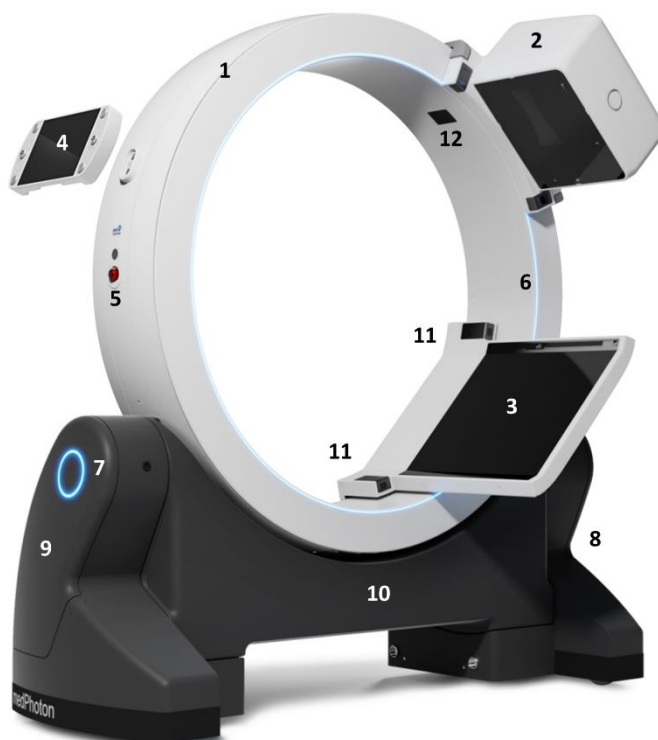
Obrázek 3: Náhled soustavy IRm (zepředu) s hlavními součástmi. 1: brána; 2: rameno zdroje; 3: rameno detektoru; 4: ovládací panel. 5: kontrolka nouzového zastavení [E-stop] a kontrolka záření; 6: LED kontrolka stavu brány; 7: LED kontrolka dvojnohého pojezdu; 8: Levá noha dipodu; 9: pravá noha dipodu; 10: nosník prstence; 11: kamery detektoru; 12: kamery brány
