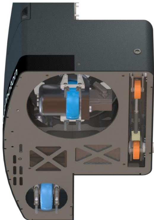
Obrázek 42: Levá noha dipodu, Nahoře: Kolečko s pohonem/řízením, Dole: Pojezdové kolečko
