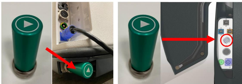
Obrázek 61: Zelená zástrčka pouze pro pohyb a příslušné umístění zástrček u Loop-X (vlevo) a IRm (vpravo).
