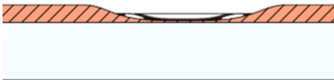
Obrázek 28: „Bowtie filtr pánev“ na řezu
