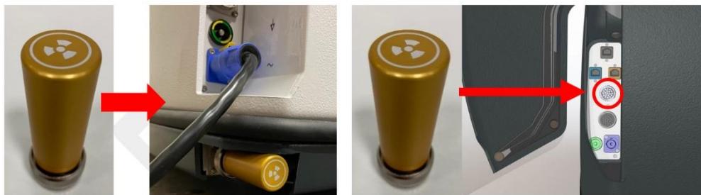
Obrázek 62: Žlutá zástrčka pro pohyb i rentgenové záření a odpovídající umístění zástrček pro Loop-X (vlevo) a IRm (vpravo).
