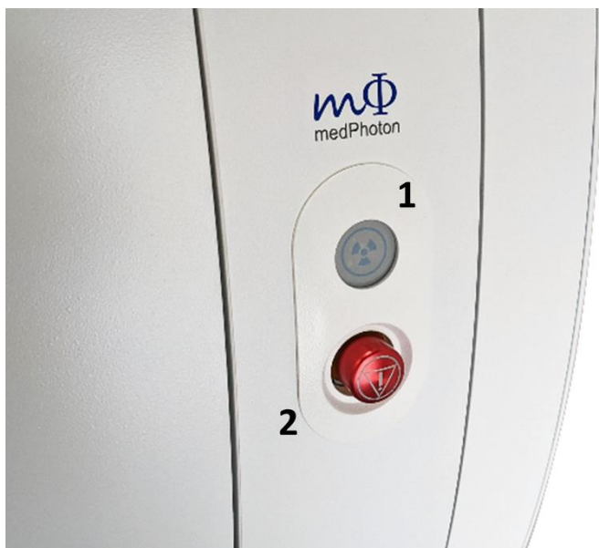
Obrázek 54: Umístění tlačítka nouzového zastavení a kontrolky rentgenky na stacionárním středovém prstenci gantry, 1: kontrolka rentgenky, 2: tlačítko nouzového zastavení
