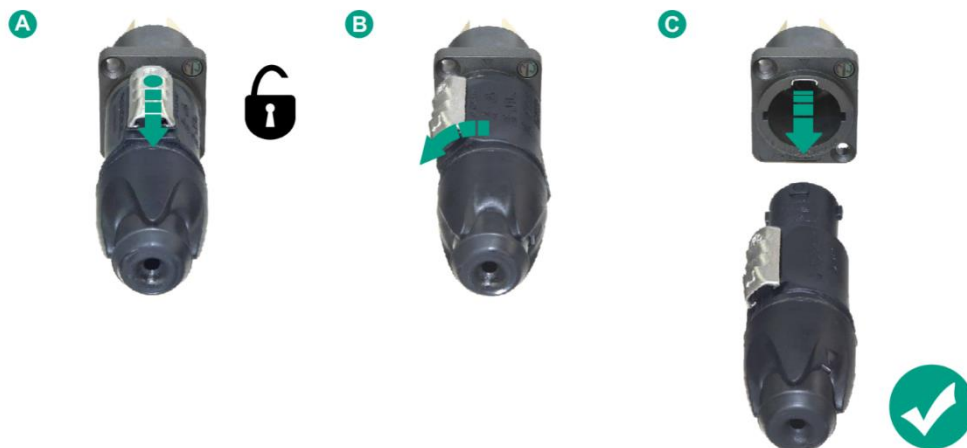
Obrázek 58: Postup odjištění elektrické zástrčky: (A) Přitáhněte stříbrnou pojistku, (B) Otočte kabelový konektor proti směru hodinových ručiček pro odemknutí. (C) Odpojte zástrčku.
