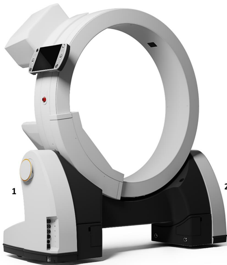
Obrázek 6: Náhled soustavy, zezadu. 1: Levá noha dipodu s elektrickými rozhraními a kabelovou podporou. 2: Pravá noha dipodu.
