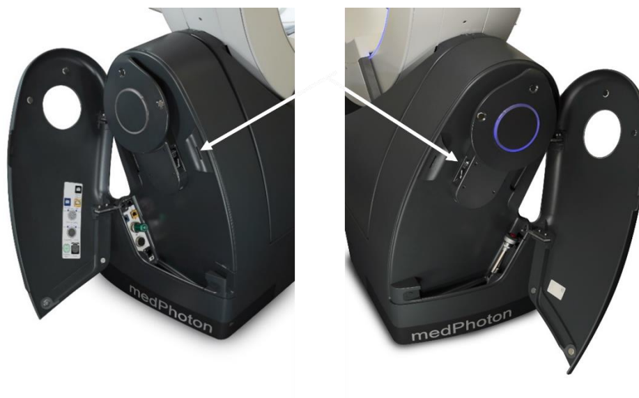
Obrázek 177: Umístění pojistek ve variantě IRm (jedna pro vnitřní 24 VDC a jedna pro 48 VDC) v obou nohách dipodu.
